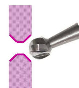
KROK 2: OBRÓBKA POWIERZCHNIOWA FREZEM O WIEKSZEJ ŚREDNICY
